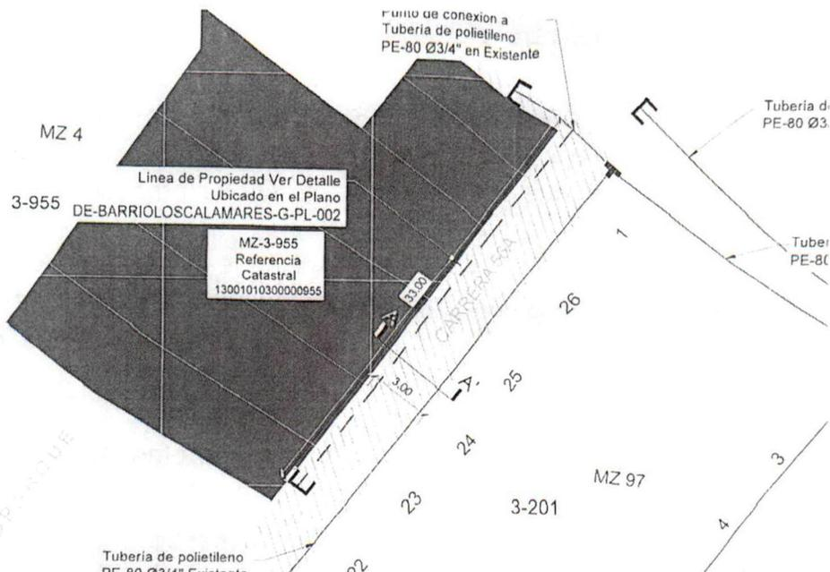
Planimetría presentada - Detalles de Instalación y excavación de tubería (Recorrido proyectado por parte de la entidad encargada)
