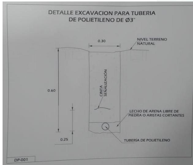
*Imagen: Detalle de excavación para tubería de polietileno de 3"*
