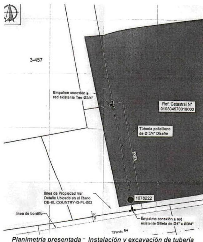
Planimetría presentada - Instalación y excavación de tubería
